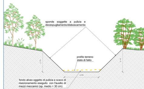
SEZIONE P15: INTERVENTO MANUTEZIONE IDRAULICA ALVEO scala 1:100
